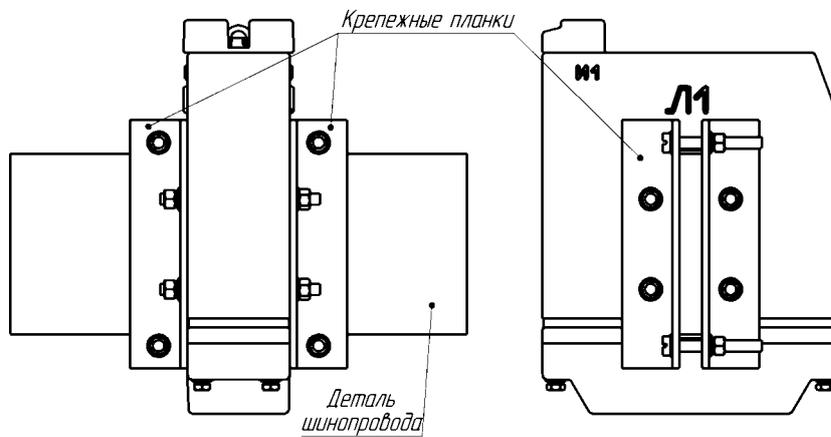
Рисунок А.3 – Крепление трансформатора на шине
