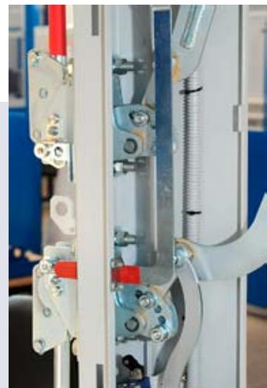
*Механическая блокировка привода*
