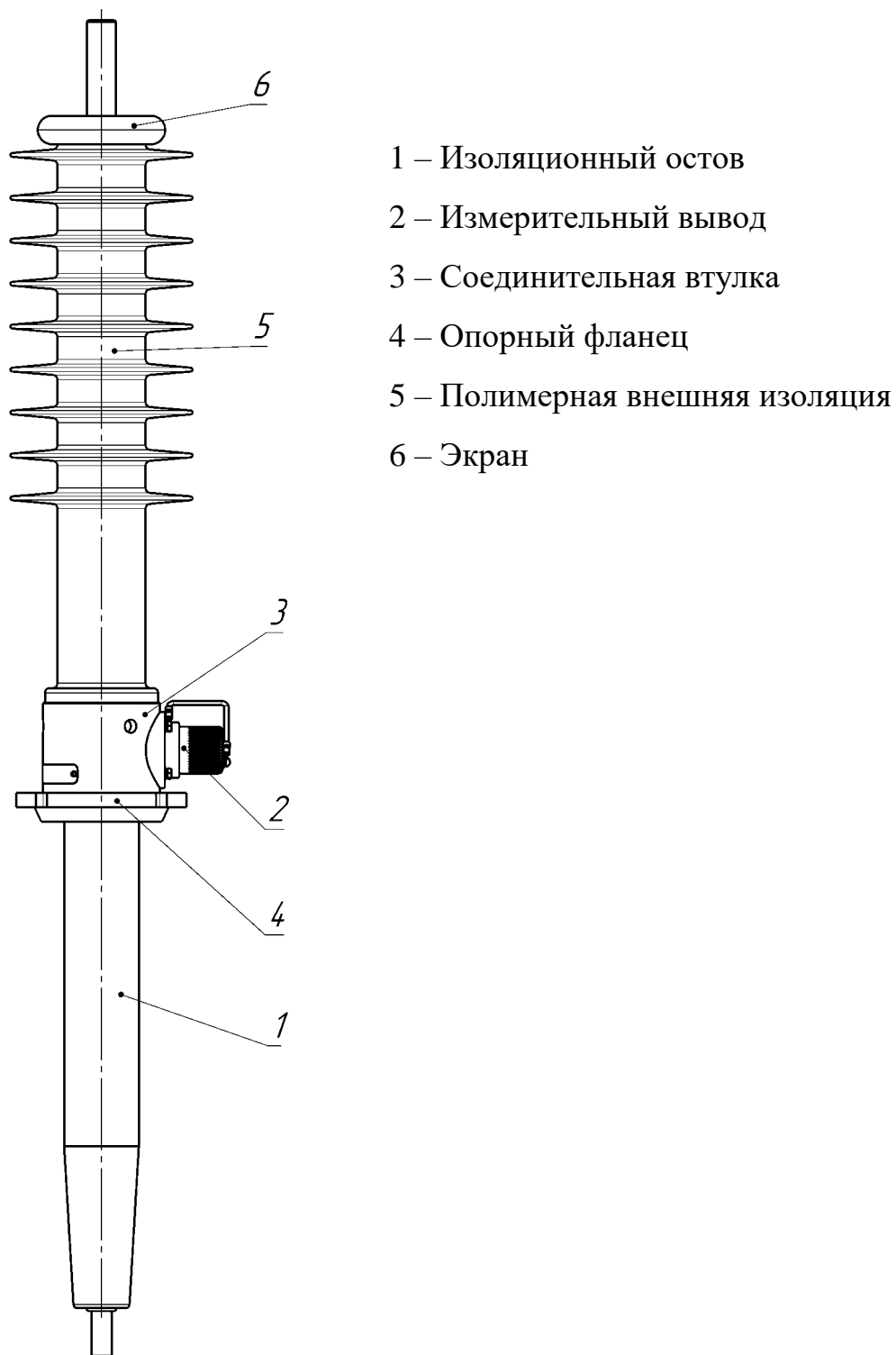
Рисунок А.1 – Конструкция ввода
