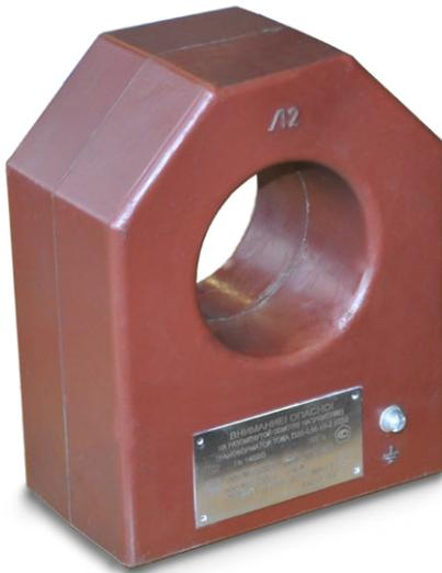
Трансформаторы предназначены для передачи сигнала измерительной информации приборам измерения, защиты, автоматики, сигнализации и управления в электрических цепях переменного тока частотой 50 Гц на номинальное напряжения до 0,66 кВ включительно, в том числе для оборудования железнодорожного подвижного состава и соответствуют требованиям ГОСТ Р 55364, ГОСТ Р 55434 и ГОСТ 33798.1.
