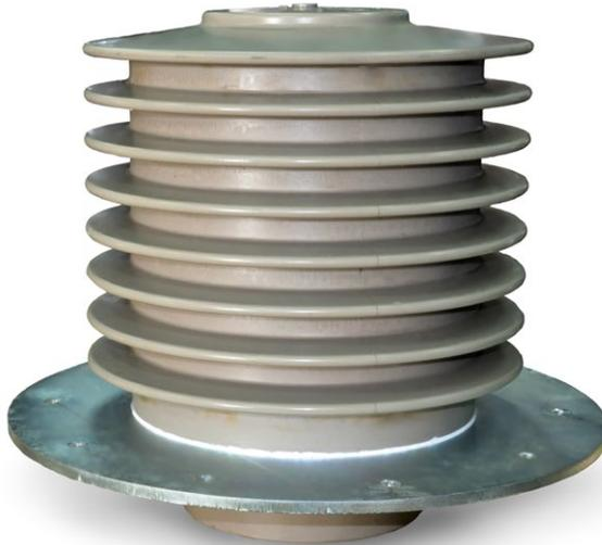
Трансформатор предназначен для преобразования высокого напряжения контактной сети с номинальным напряжением первичной обмотки 25 кВ, 50 Гц переменного тока в низкое, гальванически развязанное напряжение для питания устройств учета электроэнергии, для измерения величины напряжения контактной сети системой управления электровоза, электропоезда и тяговыми преобразователями.
